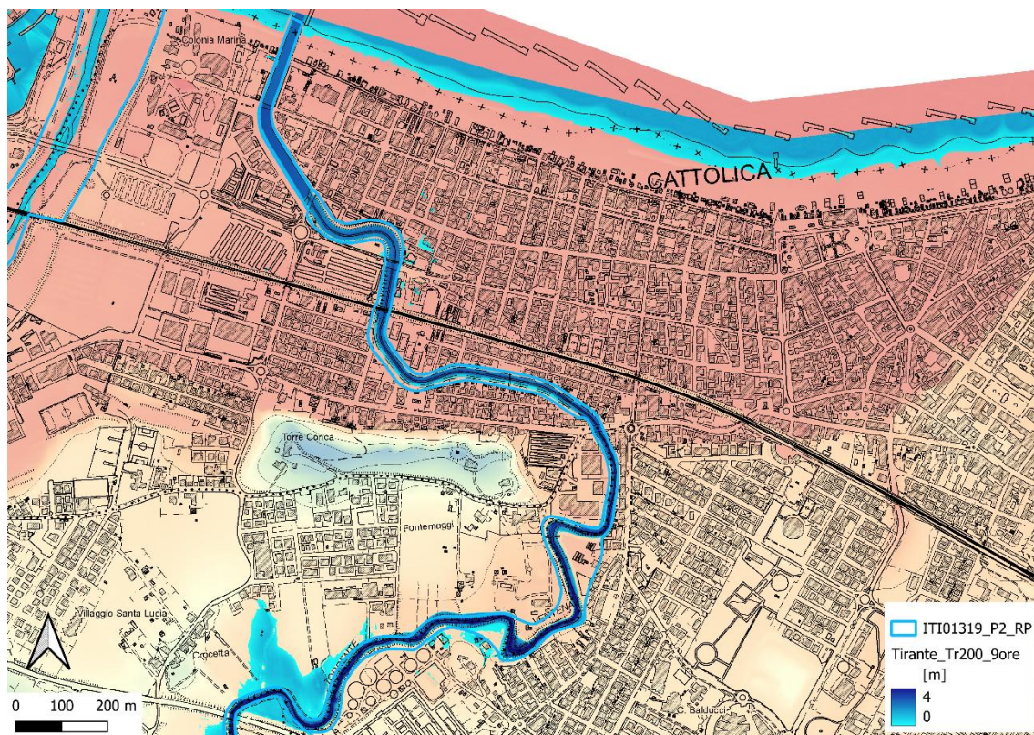
Fig. 12 T200: massimi tiranti simulati alla foce e confronto con perimetrazione P2 PGRA 2021
