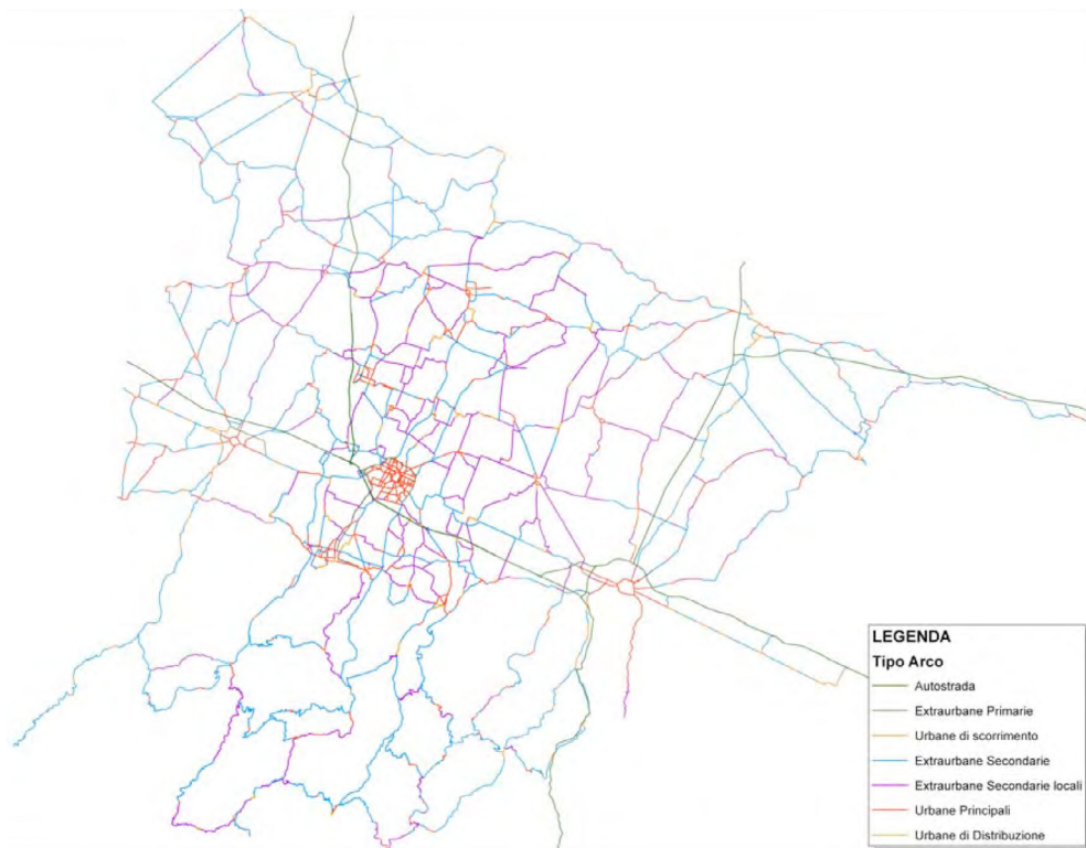
Fig. 2.4 - Grafo della rete stradale dei dintorni di Modena
