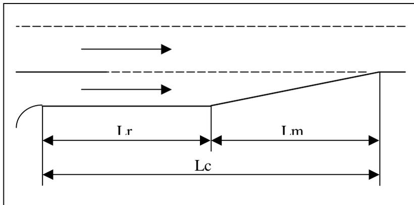
Figura 2 : Schema dimensionamento corsia di accelerazione
