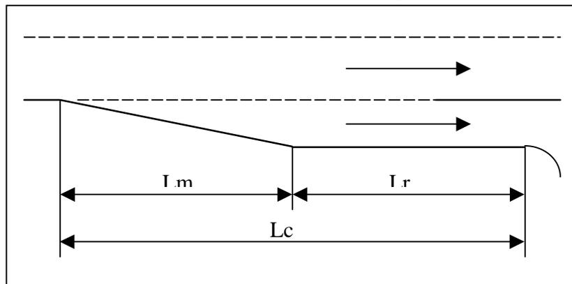
Figura 1 : Schema dimensionamento corsia di decelerazione
