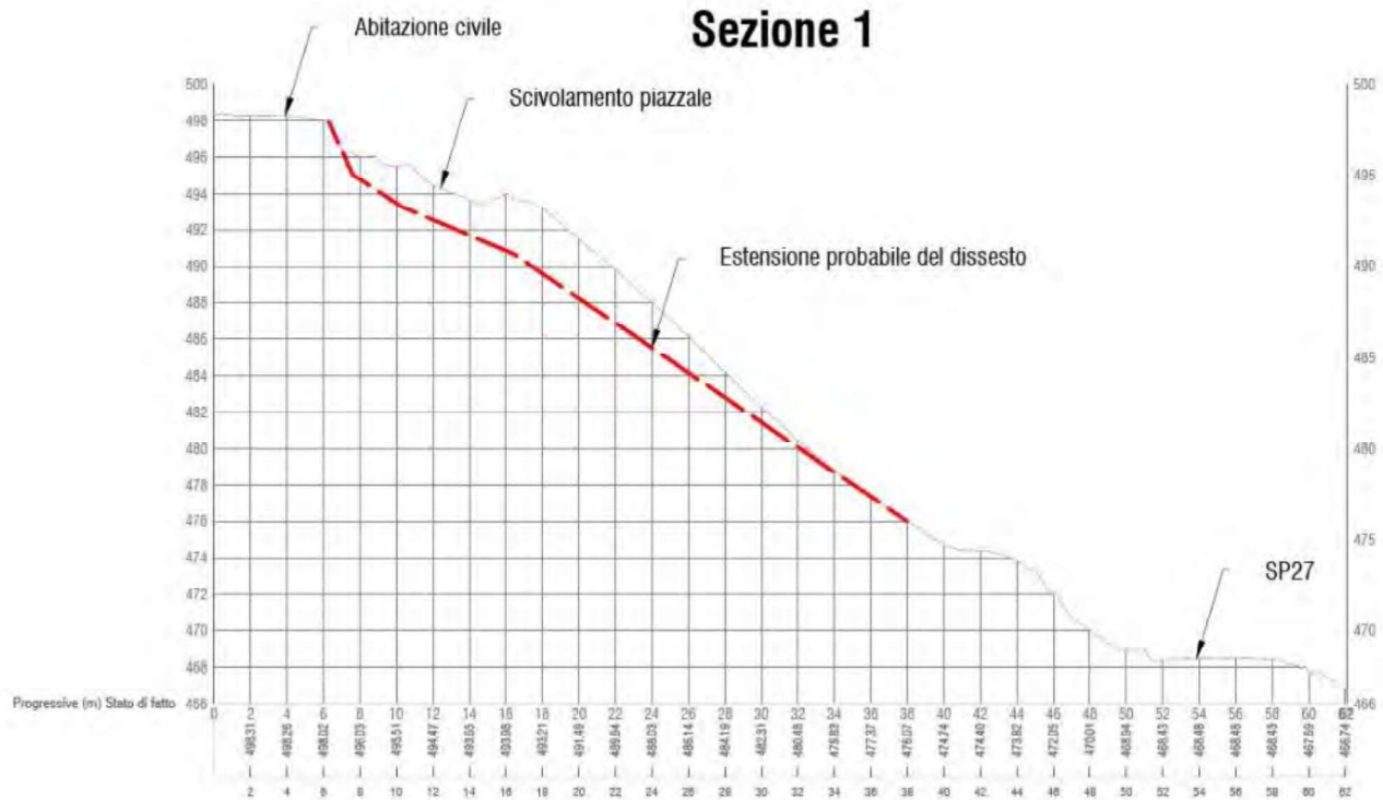
[Figura n. 3 – Sezione schematica del dissesto e dell'andamento topografico rilevato mediante rilievo fotogrammetrico in data 19/03/2025]
