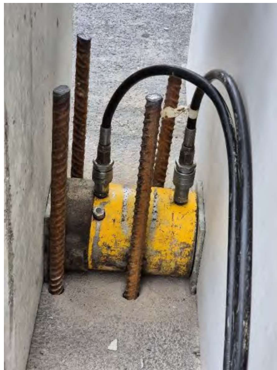
[Figura n. 12– Ripresa fotografica del punto di misura delle deformazioni (sinistra) e del punto di applicazione della forza (destra)]
